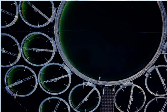
24 Versuchszylinder trennen Wasserkörper von je 9 Meter Durchmesser, 20 Meter Tiefe und 1270 Kubikmeter Volumen vom restlichen See ab. Sie sind sowohl miteinander als auch mit dem umlaufenden Schwimmsteg verbunden, der als Wellenbrecher dient. Mit einem Ankersystem wird das Abdriften der Anlage verhindert. Alle 24 Versuchszylinder sind mit Arbeitsbrücken ausgerüstet.
